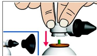
2. Schütteln Sie die Dose kräftig vor dem Einsatz. Drehen Sie die Dose auf den Kopf (Sprühkopf nach unten). Drücken Sie den Sprühkopf des Adapters in eine Düse. Sprühknopf drücken, bis das System vollständig ausgeschäumt ist. Benachbarte Düsen zuhalten. Vorgang bei mehreren Düsen wiederholen.
