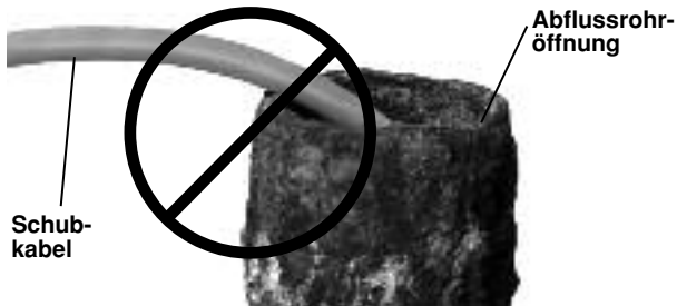
Abbildung 18 – Nicht im spitzen Winkel ziehen
