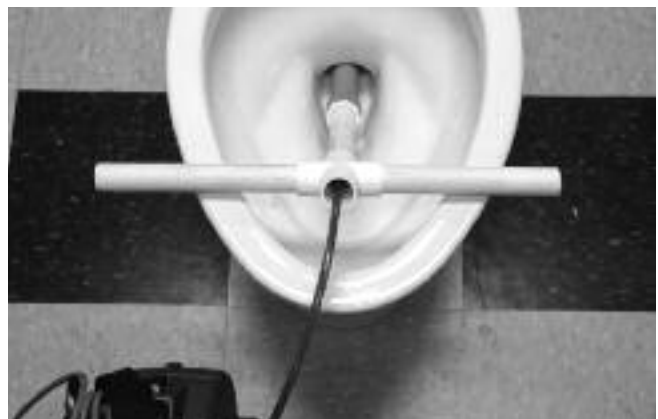
Abbildung 24 – Verwendung eines PVC-Führungsrohrs
