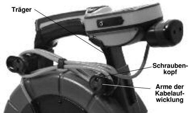
Abbildung 9 – Trägerstütze und Arme der Kabelaufwicklung
