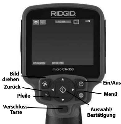
Abbildung 2 - Bedienelemente der Display-Einheit
