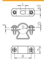
Мав А 52,00 mm Maß B 39,00 mm Maß b 14,00 mm Maß D 23,00 mm Maß D 23,00 mm Maß L 10,00 mm Мав х 9,25 mm  $\checkmark$ Abstand zur Wand Anzahl der Kabel/Rohre 1,00 Ausführung geschlossen Befestigungsart Schraubloch Geeignet im Brandschutzbe- $\checkmark$ reich Größe Pg16 Halogenfrei  $\checkmark$ Kunststoffummantelt Lochgröße 6,5 x 10 mm Materialstärke 1,50 mm Schraube M5 x 16 21,00 - 23,00 mm Spannbereich D UV-beständig  $\checkmark$
