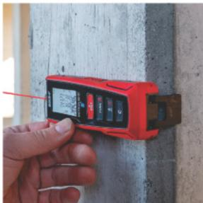
Das Endstück des METRON 60 BT kann im Winkel von 90° ausgeklappt werden und dient als Anschlaghilfe bei Messungen ab Außenkanten.
