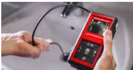
Einfache und schnelle Siphon-Inspektion vor Demontage
