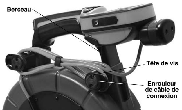
Figure 13 – Berceau et enrouleurs de câble de connexion
