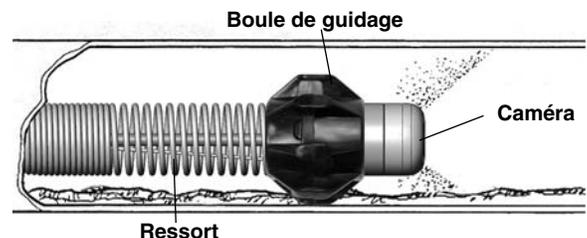
Figure 16 – Boule de guidage en cours d'utilisation
