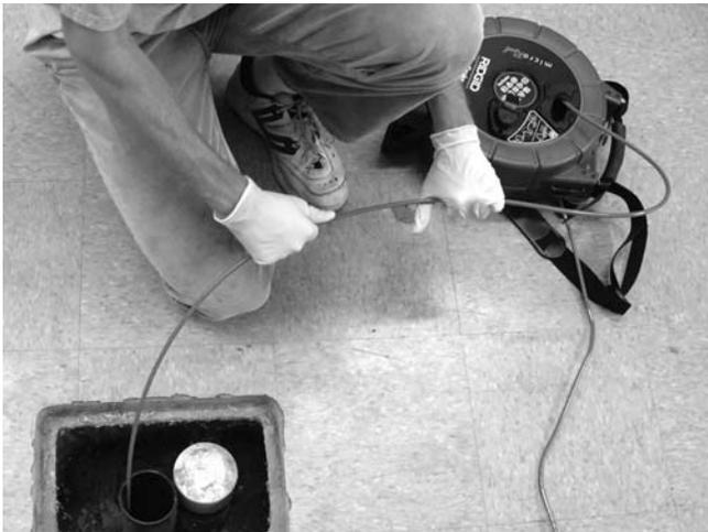
Figure 29 – Un câble bouclé risque de se plisser lors de son rembobinage
