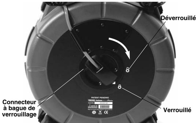
Figure 11 – Verrouillage du connecteur
