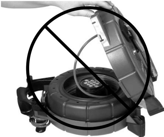
Figure 10 – Ne pas laisser le câble se débobiner
