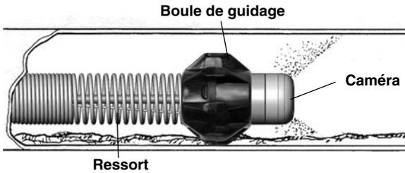
Figure 24 – Fonctionnement des boules de guidage
