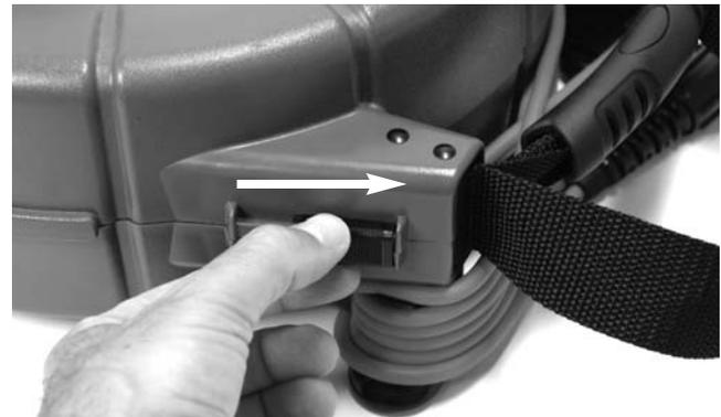
Figure 4 – Ouverture des loquets de l'enrouleur microReel
