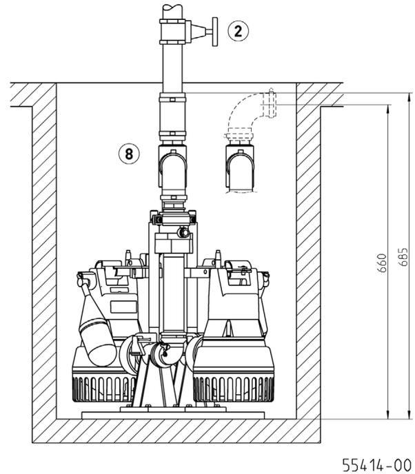
Poste simple avec barre de guidage : cuve min. 40x50 cm ou Ø 50
