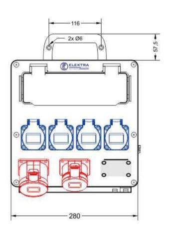
Steckdosen-Kombination im Kunststoffgehäuse, spritzwassergeschützt, Tragegriff oben 2 vorgeprägte Einführungsöffnungen M40 für fachgerechten Zuleitungsanschluss, Farbe: lichtgrau RAL 7035, Schutzart IP X4,
