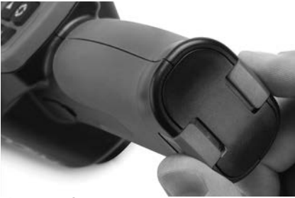
Figure 3 – Couvercle du logement de piles
