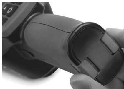
Figur 3 – Lock över batteriutrymmet
