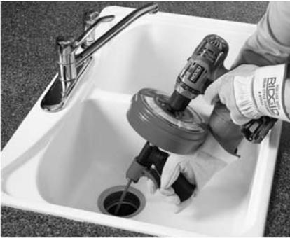
**Abbildung 8A – Power-Spin mit Akkubohrmaschine angetrieben**
