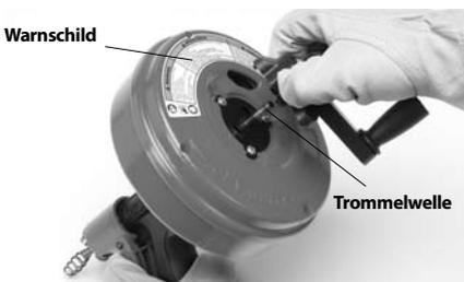
**Abbildung 2 – Entfernen des Kurbelgriffs von der Power-Spin Maschine**
