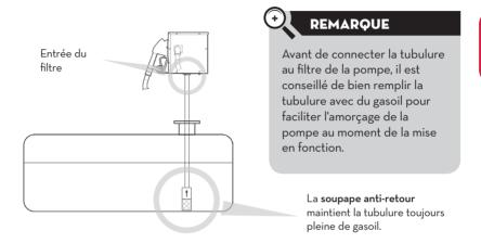
Connexion de la tubulure au distributeur CUBE Visser l'autre extrémité de la tubulure au filtre de la pompe.
