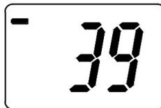
Der Countdown startet bei. Wenn der Countdown 00 erreicht, dann wird der Sensor auf 0 gesetzt. In der linken oberen Ecke wird der Batteriezustand angezeigt, unter dem Messwert die Einheit ppm.
