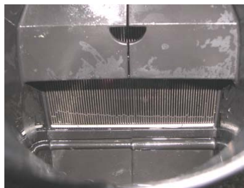
Photo de revers de tamis nettoyé au jet d'eau haute pression depuis la face avant
