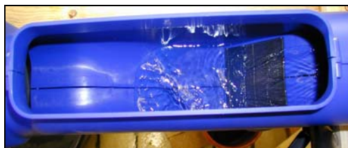
Nettoyage du filtre grâce aux tourbillons
