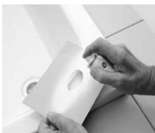
Agitez énergiquement la bombe aérosol avant l'utilisation pendant **3 min**. Pulvérisez le produit sur l'échantillon (à une température minimale de 20°C). Appliquez le spray à une distance entre 15 - 20 cm **finement**.
