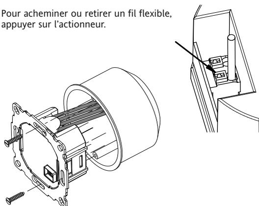
Les fils doivent être montés de manière à ce que la bande en plastique agisse comme isolation par rapport à la vis de fixation.
